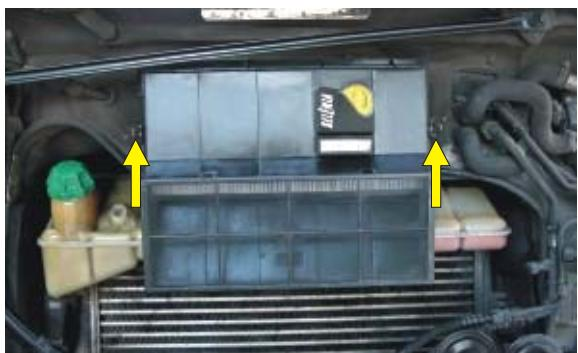
**PL** Odpiąć klipsy zabezpieczające obudowy filtra
